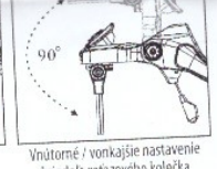
Vnútrné / vonkajšie nastavenie hriadeľa reťazového kolečka
