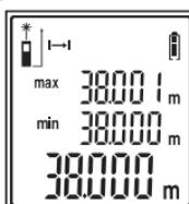
Протягом усього континуального вимірювання, пристрій буде видавати звуковий сигнал.
