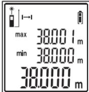
Po celou dobu kontinuálního měření bude přístroj vydávat akustický signál. Kontinuální měření můžete dočasně přerušit krátkým stiskem tlačítka ON. Pokud chcete pokračovat v kontinuálním měření, stiskněte dlonou tlačítka ON.
